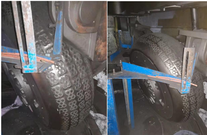
燃煤热电厂立磨 ZGM95G DJM 陶瓷复合辊套使用 4000 小时后 DJM MMC Roller (ceramic insert roller) after 4000hour
