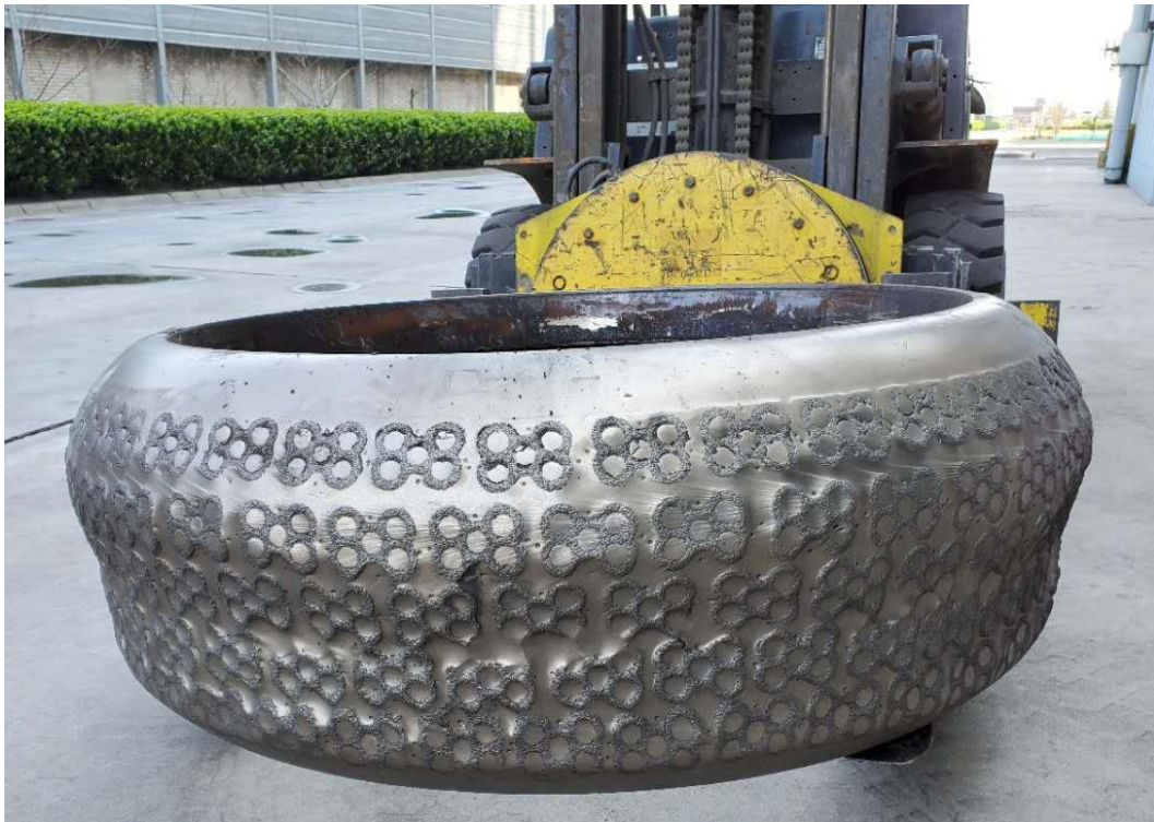
使用 13000 小时后 MMC roller after 13000 hour
