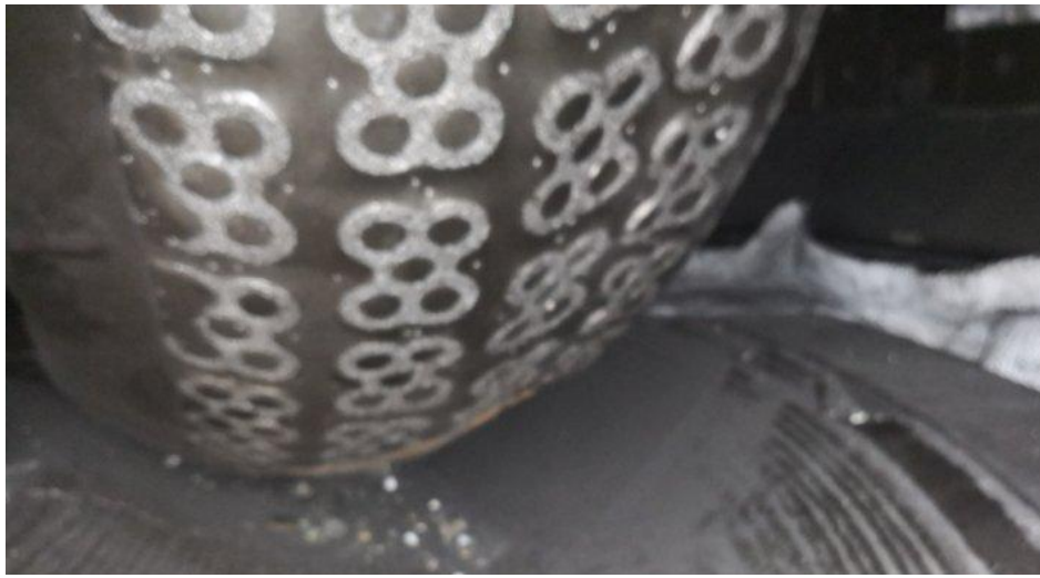
使用 4000 小时后 MMC roller after 4000 hour
