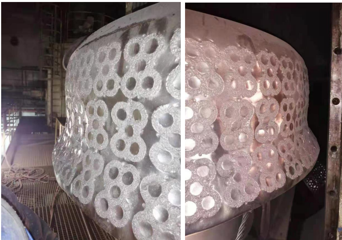
使用 8760 小时后 MMC roller after 8760 hour 磨耗量 22-26mm
