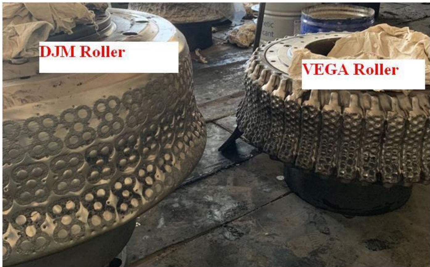
使用 13460 小时后 MMC roller after 13460 hour 磨耗量 36-41mm
