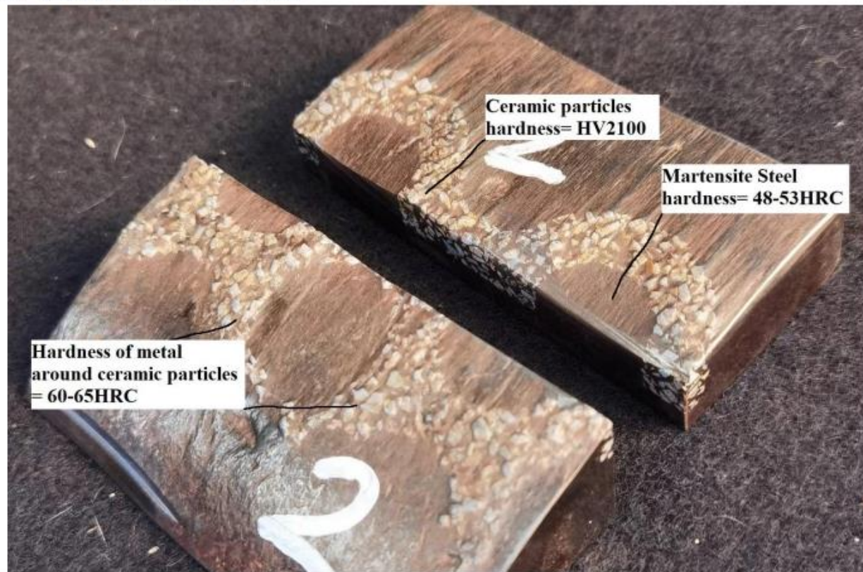
附：金属陶瓷复合衬板硬度阶梯分布图
